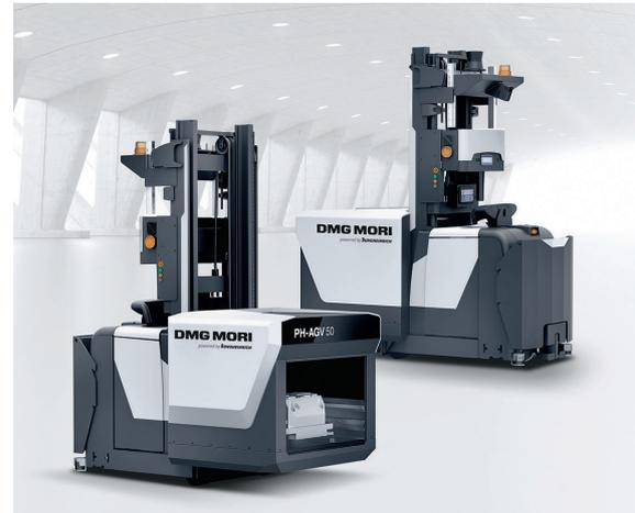
3 Das PH-AGV 50 ist für Werkstücke bis  $840 \times 500$  mm und 600 kg ausgelegt (© DMG Mori)
